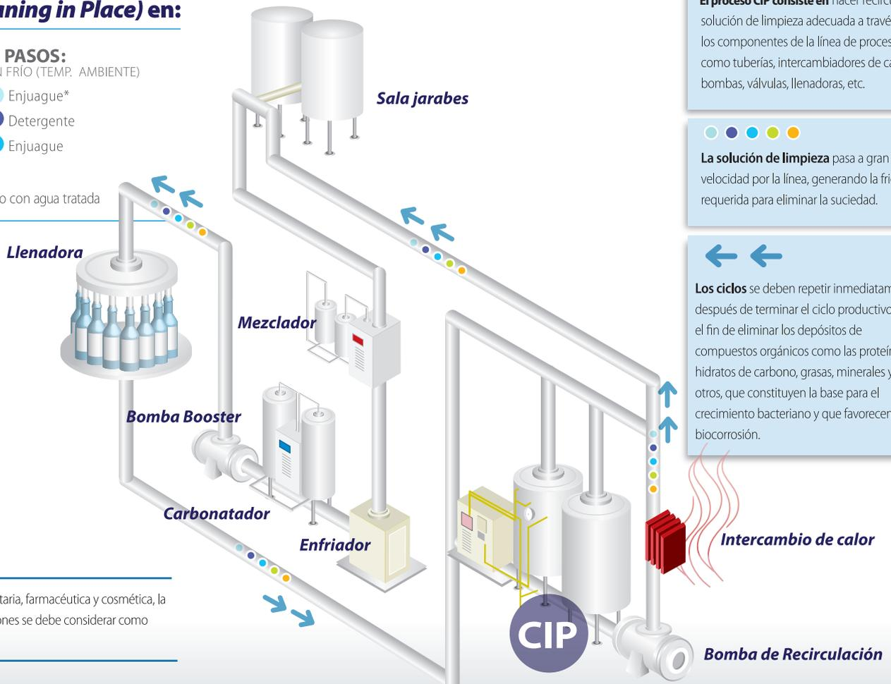
El proceso CIP consiste en hacer recircular la solución de limpieza adecuada a través de los componentes de la línea de proceso como tuberías, intercambiadores de calor, bombas, válvulas, llenadoras, etc.
