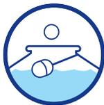
Coloque pastilla de Clorprol 65 en la caída de agua del tinaco o cisterna.
