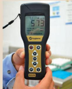
El **Luminómetro** es la herramienta con la que hacemos mediciones para detectar el nivel de contaminación de la superficie, tanto de origen microbiano como no microbiano, así como para validar la efectividad de la limpieza, y demostrar la reducción de estos niveles después de ser limpiadas con nuestros productos.
